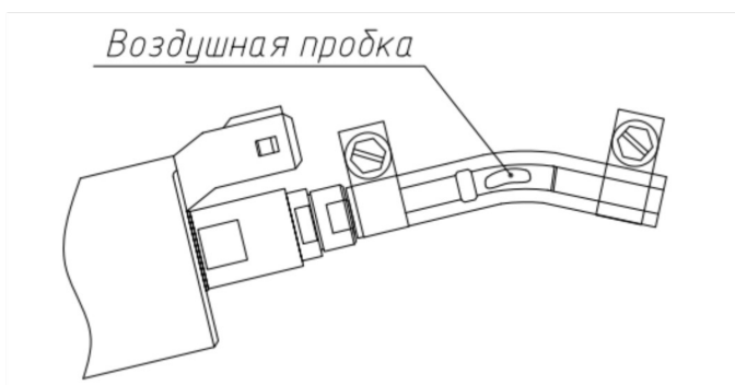
Рис. 7 а) Неправильная прокладка магистрали—образование воздушных пробок
