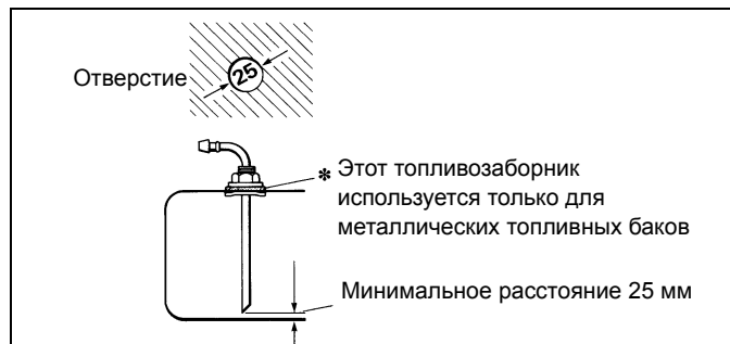
Рис.11: Топливозаборник Webasto из бака
